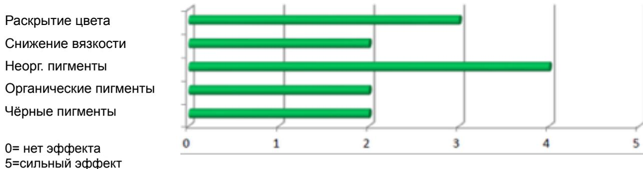
UNIQSPERSE 764 S – смачивающая и диспергирующая добавка с контролируемой флокуляцией для органорастворимых систем средней и высокой полярности чтобы предотвратить оплывы и всплытия диоксида титана в сочетании с цветными пигментами. Не содержит силикона.
